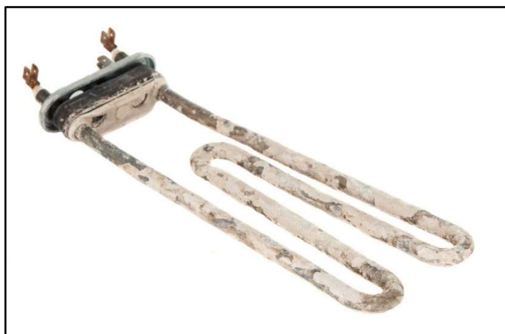
Abbildung 1: Heizelement mit Kalkablagerungen
