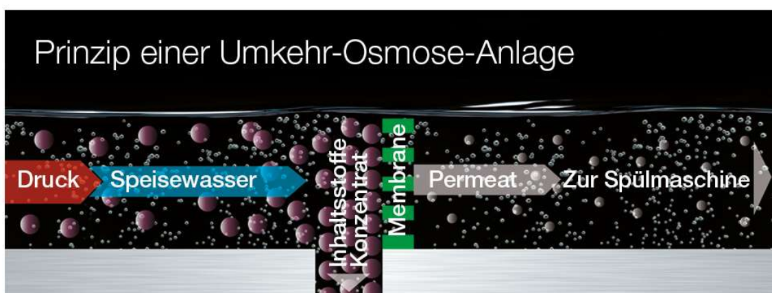
Abbildung 5: Funktionsprinzip einer Umkehrosmose- Anlage
