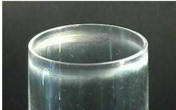
Bild 1: Lokale Trübung am Mundrand (Quelle: Kurzreferate, 77. Glastechnische Tagung Leipzig 2003, S. 55-58)
