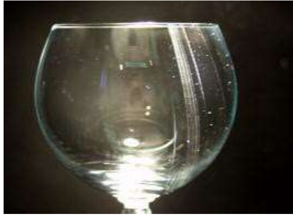
Bild 3: Linienkorrosion (Quelle: Kurzreferate 77. Glastechnische Tagung Leipzig 2003, S. 55-58)
